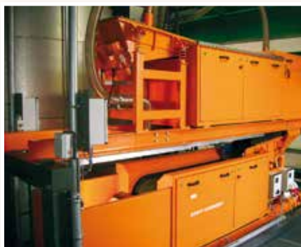
Каскадное расположение сепараторов цветных металлов для отделения металлических частиц 2-10 мм от шлака
