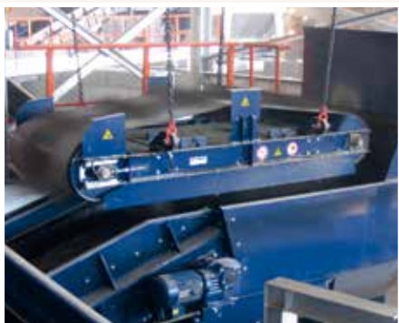
Подвесной постоянный сепаратор расположен продольно транспортной ленте
