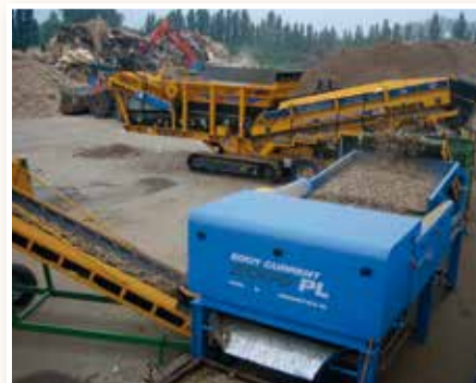
Сепаратор цветных металлов с шириной ленты 2000 мм при сепарации отходов древесины
