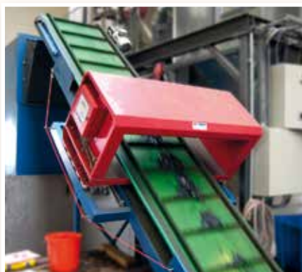
Металлодетектор установлен в конвейерной ленте при рециклинге пластмассы
