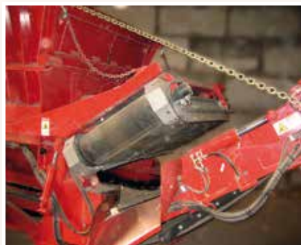
Подвесной сепаратор NEOFLEX® (легкий и компактный) установлен на дробилке древесины
