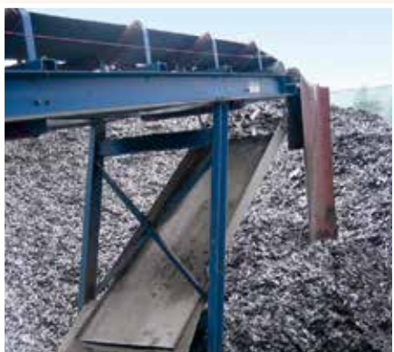
Разделение частиц железа из измельченного алюминия
