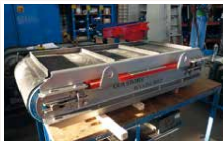
Магнит Ecoline в стандартном выполнении из нержавеющей стали
