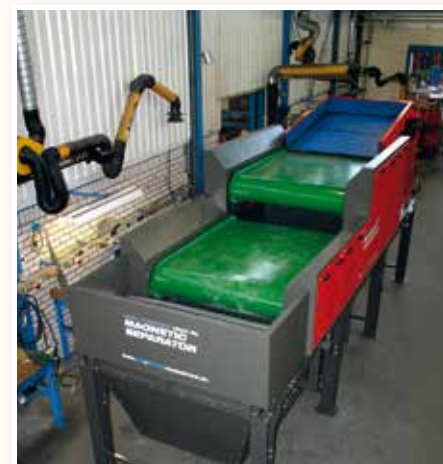
Магнитный сепаратор с высоким градиентом 1500, двухэтапная версия для вторичной переработки пластмассы
