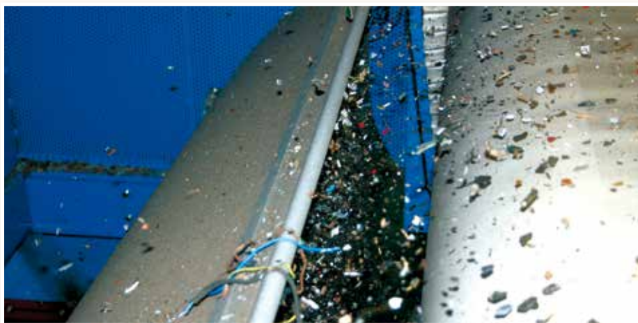
Деталь сепаратора цветных металлов (ширина 1500 мм) для сортировки отходов WEEE
