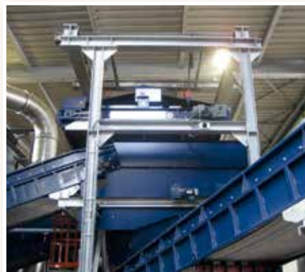
Электромагнитный подвесной сепаратор для отходов строительства и сноса
