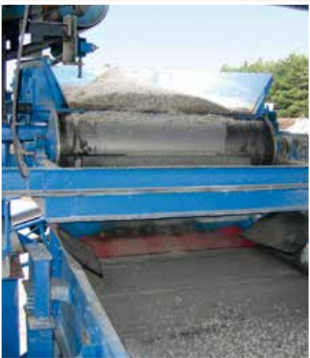
Барабанный сепаратор с магнитами NEOFLUX® для стекольной промышленности
