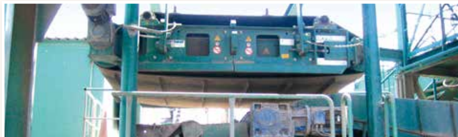
Электромагнитный подвесной сепаратор с лентой шириной 2 м для отходов строительства и сноса
