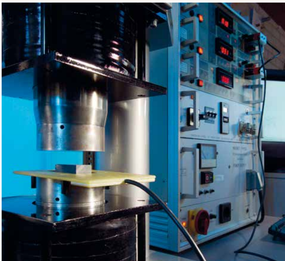
Измерительная система Permagraph определяет магнитные характеристики
